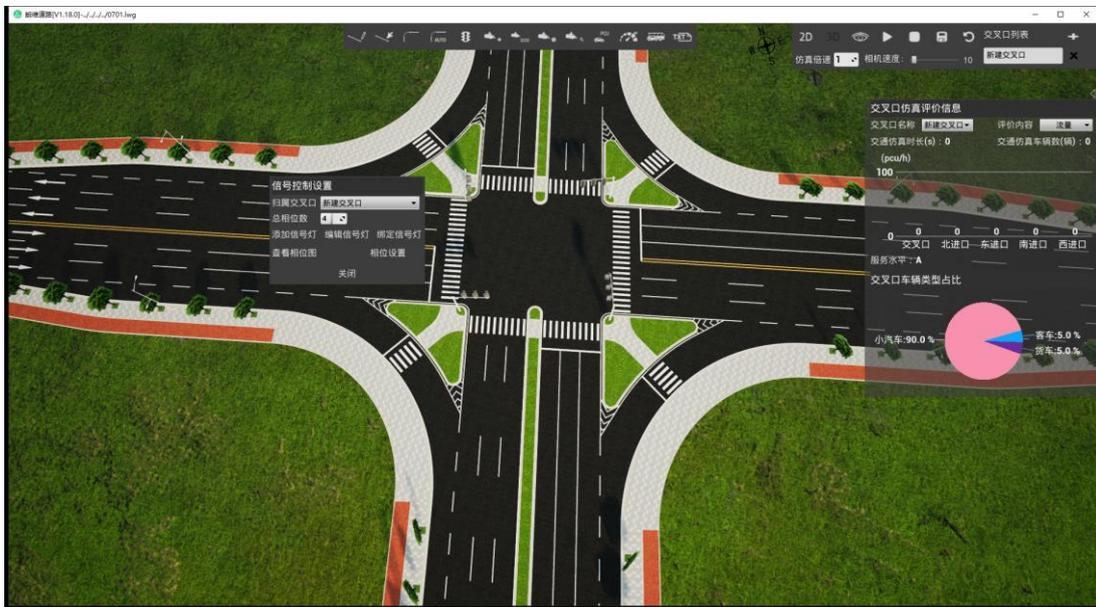
(4) 绑定信号灯。在“信号控制设置”界面点击“绑定信号灯”按钮，依次对各信号灯绑定需要受灯控影响的车道。绑定过程中可拉框进行多选。
