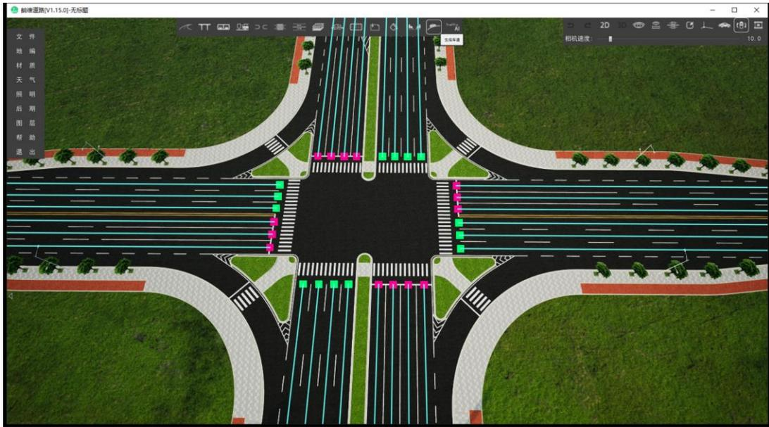
(2) 连接车道。点击界面上方“交通仿真”按钮，此时进入交通仿真系统界面，点击界面上方“连接车道”按钮，依次对各进口道车道进行连接，连接时会弹出“车道连接设置”框，根据实际情况选择合适的交叉口、进口道方向、转向，设置转弯半径及比例等参数。
