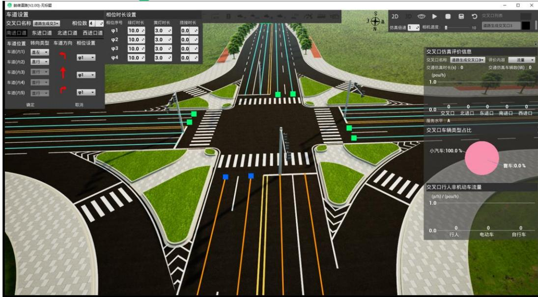
(5) “设置信号控制”功能
