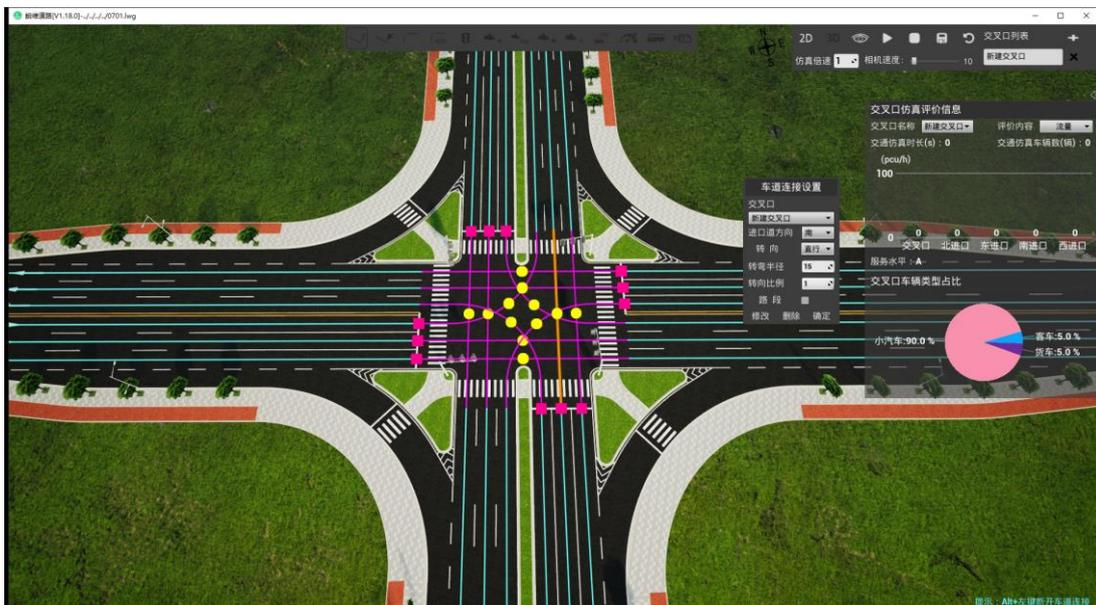
(3) 布置信号灯。点击界面上方“设置信号控制”按钮
