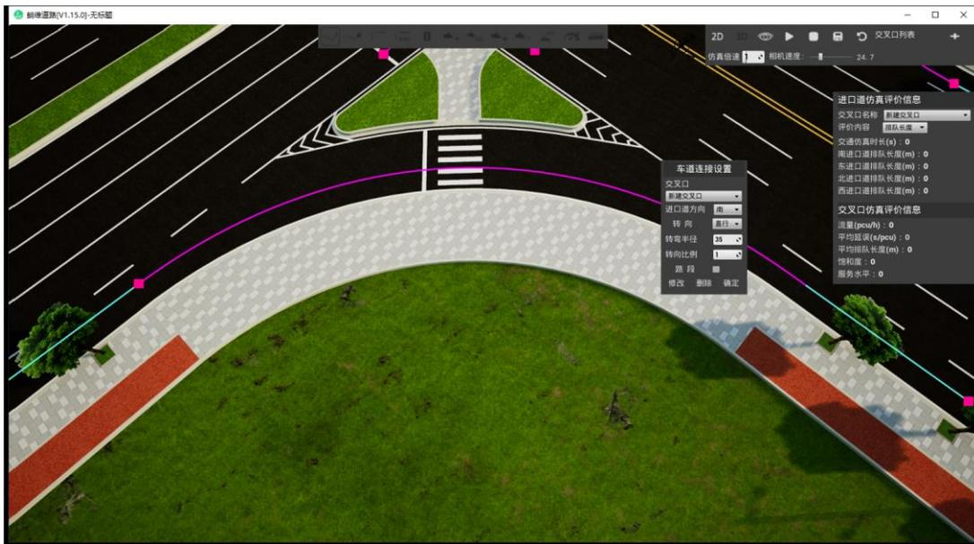
(4) “自动连接车道”功能
