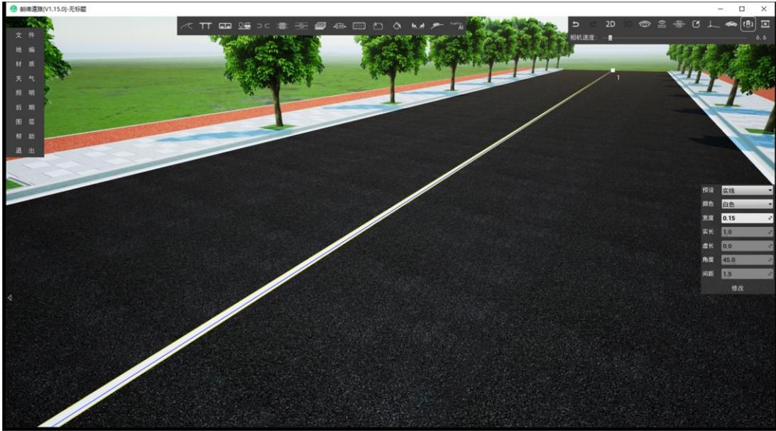
绘制标线内置多种预设样式，可用于绘制各种车道分界线，斑马线，导流线，斜线，网格线等。
