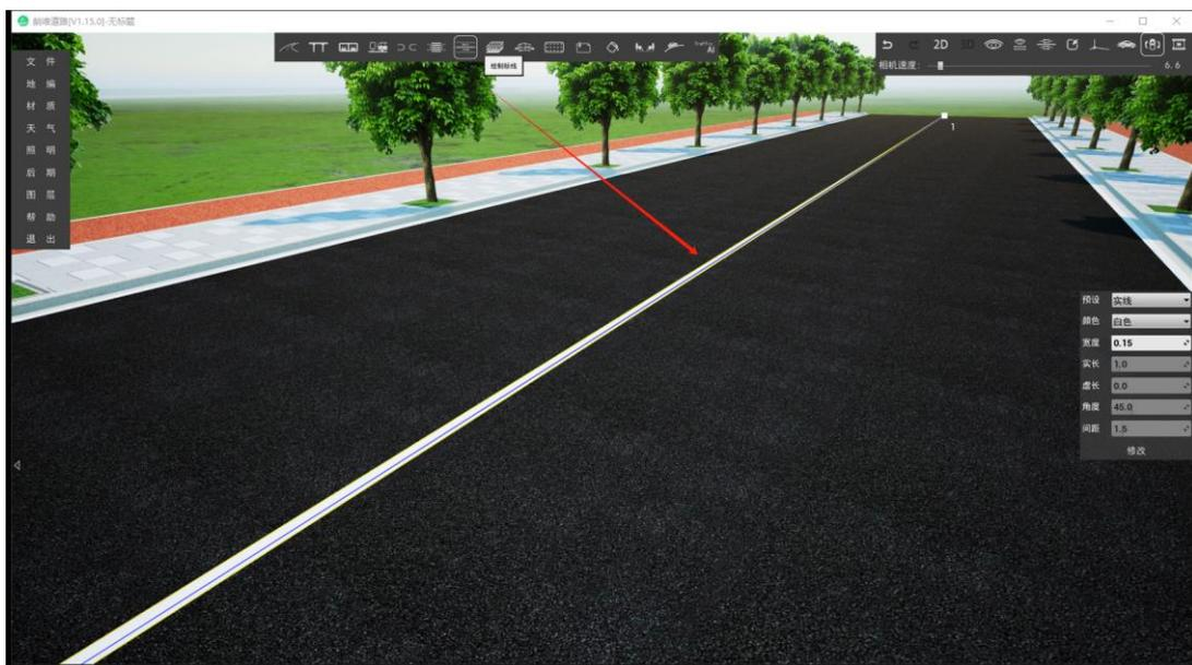
点击绘制完成的标线，界面右侧弹出标线编辑框，可在其调用该标线的预设样式，
