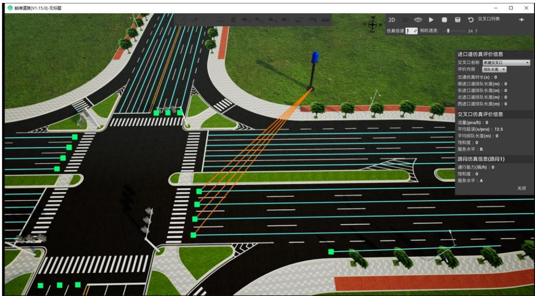
(13) “设置路段参数”功能
