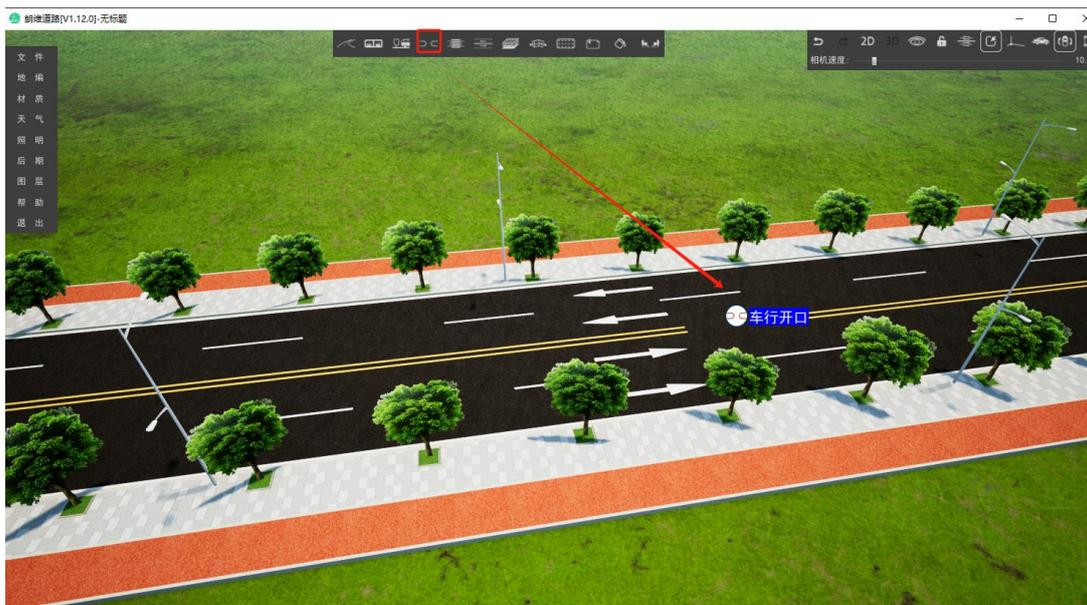
在开启道路编辑模式下，点击“行车开口”按钮，可对行车开口各项参数进行修改。
