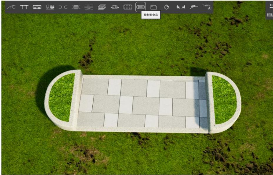
点击绘制完成的安全岛，界面右侧弹出安全岛编辑框，可对安全岛的侧石宽度、高度，安全岛总长度、总宽度，人行道净宽、高度进行修改。
