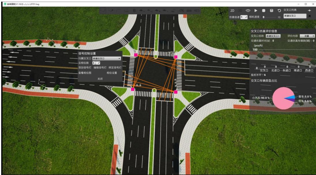
(5) 设置相位。在“信号控制设置”界面点击“相位设置”按钮，依次对各信号灯相位进行设置。设置完成后可点击“查看相位图”查看当前交叉口相位的设置情况。
