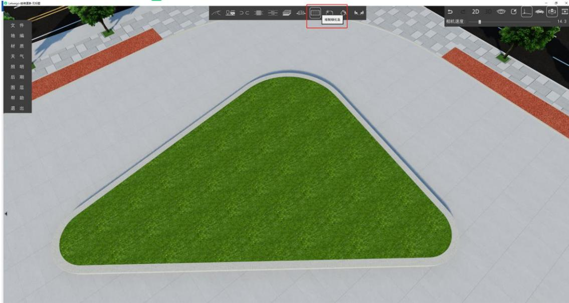
点击绘制完成的绿化岛，界面右侧弹出绿化岛编辑框，可对该绿化岛的侧石宽度、高度，倒角半径，旋转角度等进行修改。若侧石的材质出现闪烁，可尝试点击“侧石反转”或“绿地反转”按钮。
